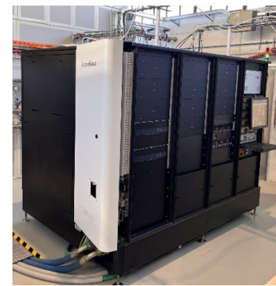
50 MW RF Source
