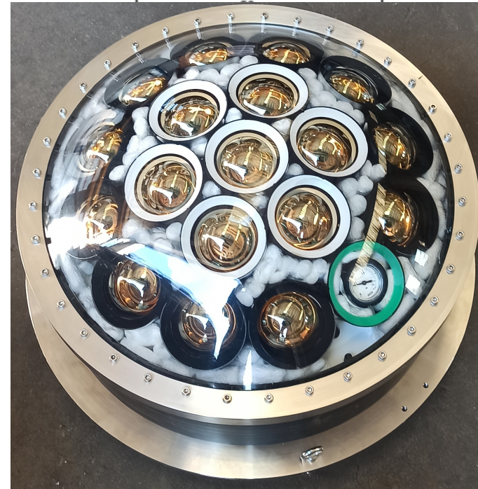
Prototipo di mPMT realizzato dall'INFN
