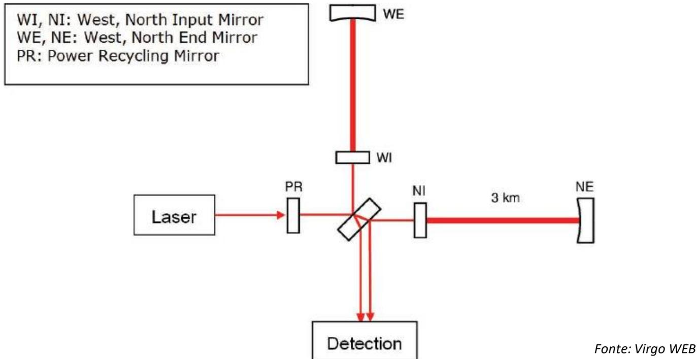
Le parti sensibili dell'interferometro, inclusi gli specchi principali, i sistemi meccanici e il fascio laser, sono mantenute sotto vuoto per ridurre vari disturbi a livelli accettabili.
