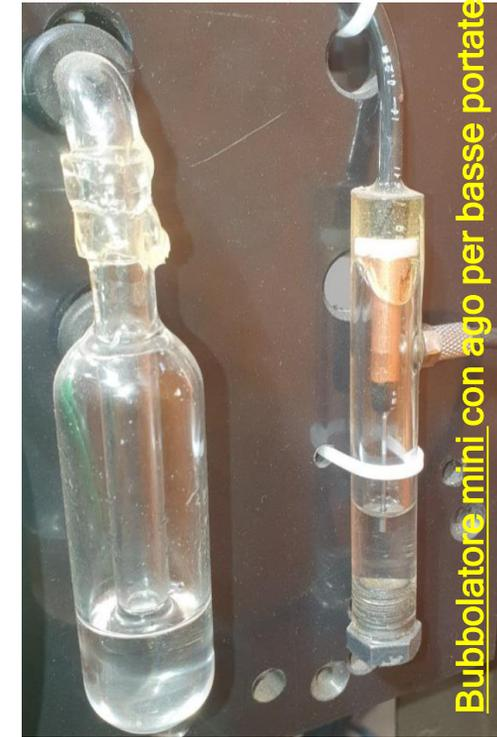
1. Il flusso li può attraversare in una sola direzione (analogia con il diodo) l'aria in uscita non può entrare nella camera in nessuna condizione.
