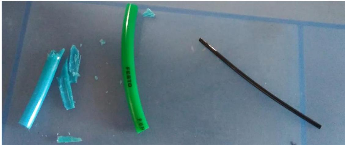
Risultati prova di immersione di durata settimanale in soluzione di HF al 10%
