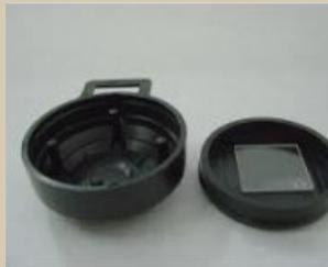
Dosimetro CR-39, si formano delle tracce dopo l'attraversamento di una particella alfa
