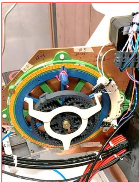
Il Sistema di posizionamento con controllo da remote è stato realizzato e al momento sembra funzionare (va tenuto in considerazione che si tratta di un setup "giovane")
