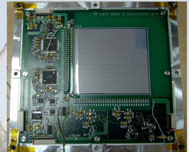
Board di Front End con rivelatori al silicio 8x8x 0.38 cm (32 strips). Un secondo rivelatore con strip ortogonali è collocato al di sotto di quello visibile in figura.
