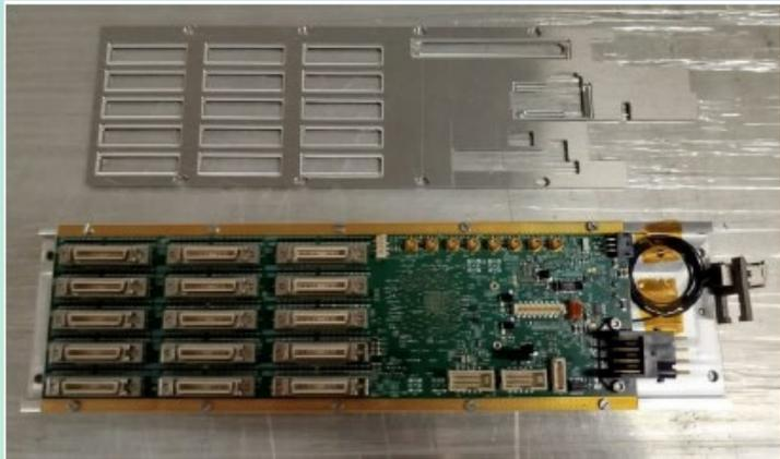
validazione della scheda OBDT (On detector Board for Drift Tube) FPGA
