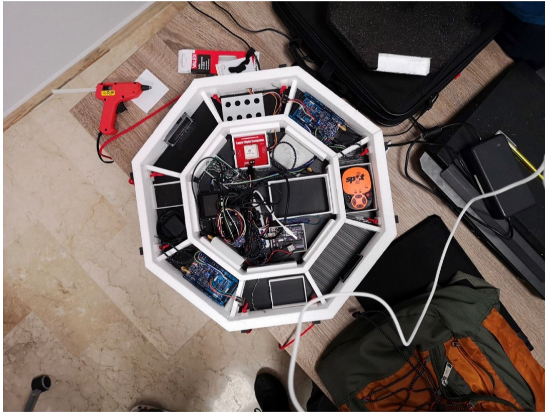
Figura 2.6. Foto del carico del pallone aerostatico per l'esperimento MoCRiS, si distinguono i due ArduSiPM e M5Stack.
