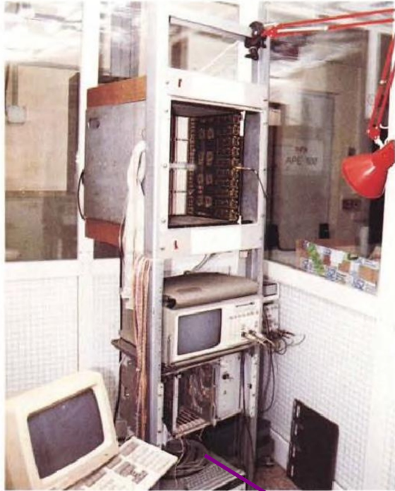
Il rack che ospita la versione attuale di APE100. Al momento sono state realizzate sei schede, per una potenza complessiva di 2,4 Gflops.
