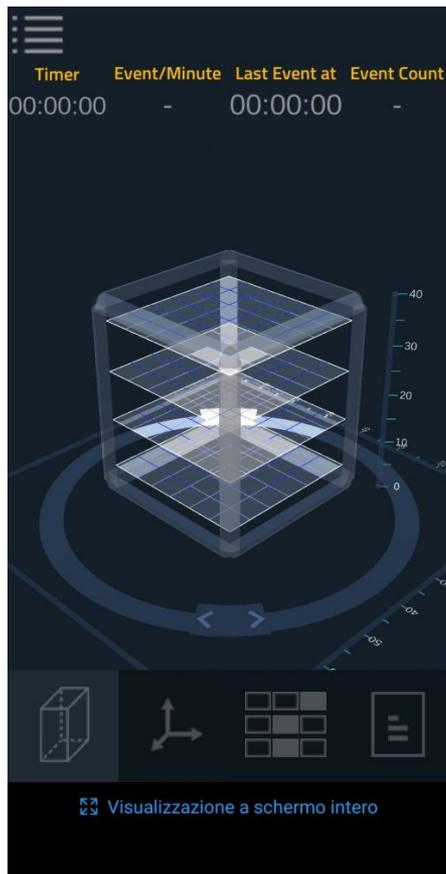
Il rivelatore è un cubo di lato 30cm, costituito da quattro moduli distanziati tra loro di 7 cm. Ogni modulo è costituito da 2 piani, ciascuno costituito da 6 bacchette scintillanti sovrapposte e posizionate ortogonalmente tra loro per consentire una lettura bidimensionale dei nostri dati → cioè possiamo leggere la traccia del muono su due piani, il piano zx e il piano zy.
