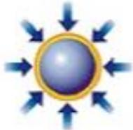
**Fase 1: irraggiamento tramite laser della capsula contenente DT**
