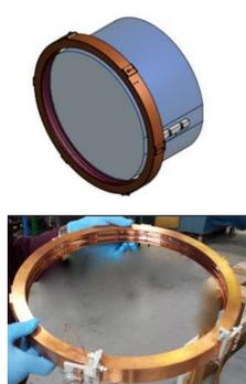
Installato attorno a ciascuno specchio dell'interferometro: ETM / ITM / PR / SR
