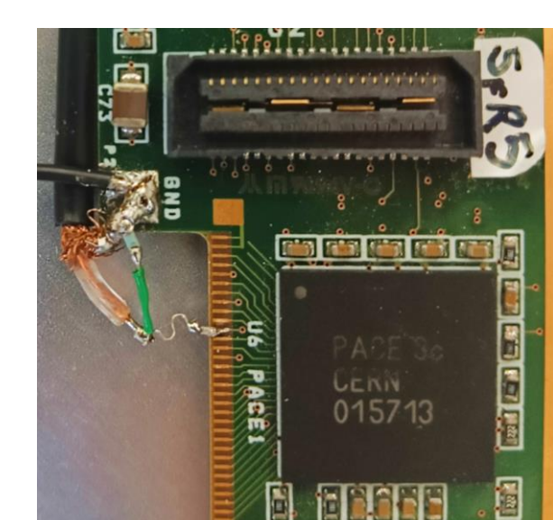
Foto del condensatore saldato su un canale del chip PACE3.
