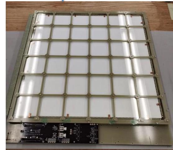
352 membrane tiles:  $60 \times 60 \text{ cm}^2$ , due canali di elettronica che leggono 80 SiPM in configurazione di ganging «ibrido»
