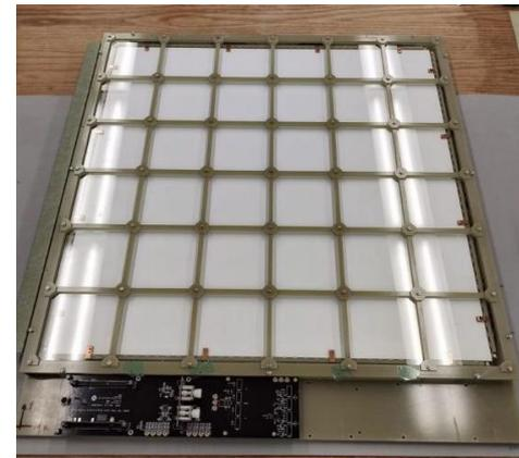
752 tiles («megacell») posizionati sul catodo o sulle pareti del criostato di FD2-VD
