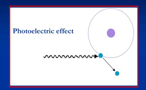
Il fotone viene totalmente assorbito e trasferisce tutta la sua energia all'elettrone detto "fotoelettrone" che viene espulso dall'atomo
