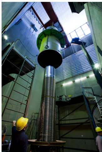
L'acceleratore CN dei Laboratori Nazionali di Legnaro, il primo a essere installato nei laboratori, è un esempio di acceleratore che sfrutta il generatore di Van de Graaf per generare l'alta tensione che accelera le cariche. © Andrea Alessio
