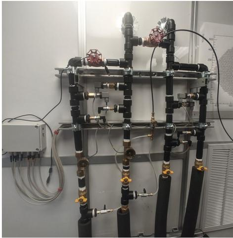
Il sistema realizzato a Fermilab è servito e servirà a fare le caratterizzazioni fluidodinamiche del sistema completo di un disco per volta. E' stato utilizzato con il fluido HFE7100, che però non sarà più disponibile.
