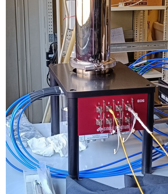
Rivelatore a nanofili superconduttivi: cryocooler 2.2 K
