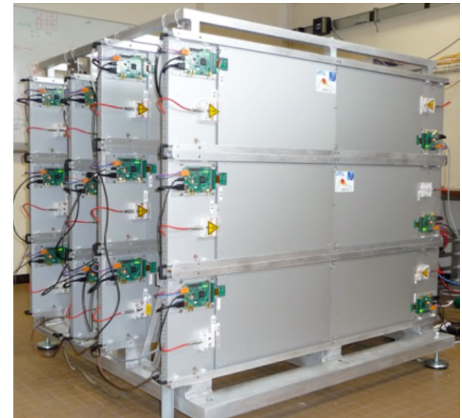
TOMUVOL telescope (RPC detectors)
