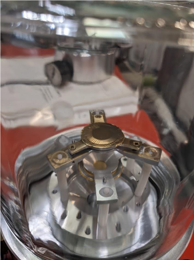
Au 150 \mu\text{g}/\text{cm}^2 on ^{40}\text{Ca} 0,8 mg/cm 2 on Au 4 mg/cm 2 plunger target PAC 23.010
