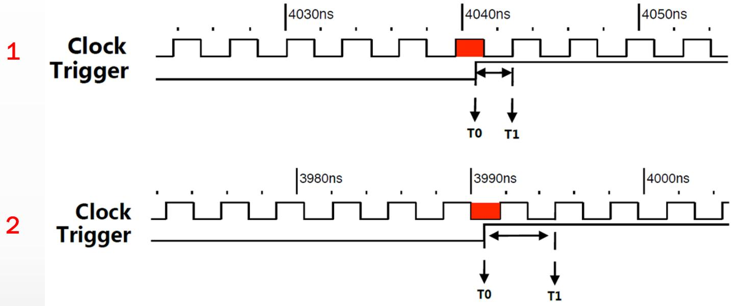
$$T = \begin{cases} (T_{coarse} \cdot \tau_{clk}) - (T_{fine} - MIN) \cdot LSB & \text{if } T_{fine} \leq CUT \\ (T_{coarse} \cdot \tau_{clk}) - (T_{fine} - MIN) \cdot LSB + \tau_{clk} & \text{if } T_{fine} > CUT \end{cases}$$
