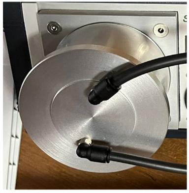
Questo strumento utilizza l'effetto fotoelettrico che trasforma il segnale di luce in segnale elettrico e si trova alla sommità della cella. Conteggia i fotoni emessi ed è collegato ad un registratore di dati.
