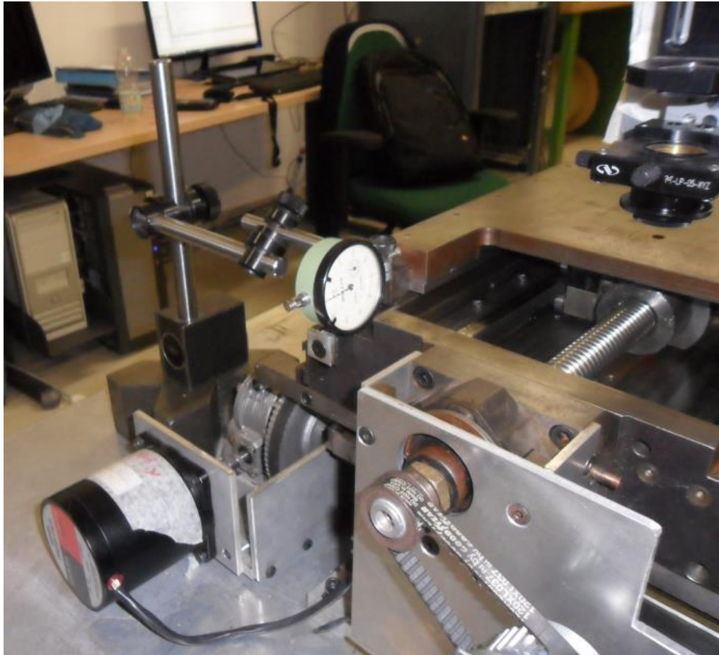
Figura 7.3: Misura dello spostamento lungo l'asse X del piano mediante il comparatore.
