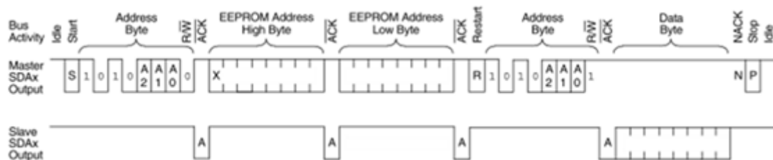
Figura 4.12: Diagramma temporale nel quale è mostrato un tipico messaggio inviato tramite I^2C .
