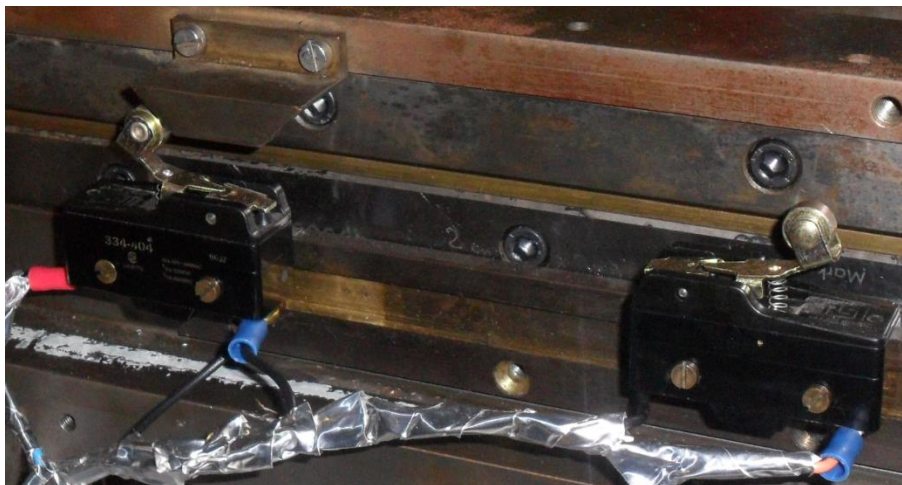
Figura 6.4: Immagine in cui vengono mostrati due finecorsa della stazione di test e il posizionamento del piano nel punto di origine.
