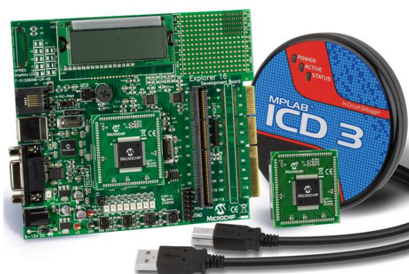
Figura 6.1: Immagine della scheda Explorer 16 con a fianco il programmatore ICD 3.
