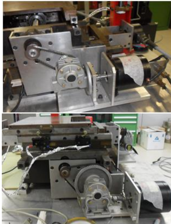
Figura 6.2: Nell'immagine di sopra si può osservare il meccanismo di trasmissione dall'albero motore alla vite senza fine relativo all'asse X, nell'immagine di sotto quello relativo all'asse Y.
