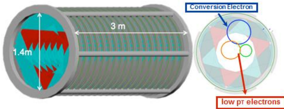
Figura 1.7: Sistema di tracciatura. Gli straw tubes sono orientati trasversalmente all'asse del Detector Solenoid. A sinistra è mostrato il sistema di tracciatura con diametro di 1.4 m e lunghezza di circa 3 m, a destra è mostrata la vista in sezione del sistema di tracciatura e sono rappresentate le traiettorie circolari di elettroni di conversione, ricostruiti nel sistema di tracciatura, e di elettroni che spiraleggiano all'interno del rivelatore e non sono ricostruiti.
