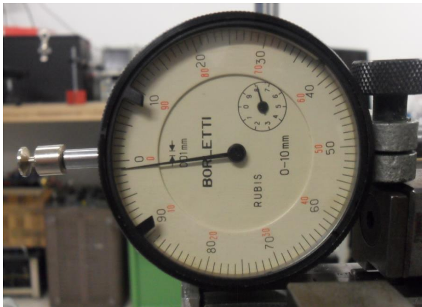
Figura 7.5: Posizione del comparatore dopo lo spostamento. Si osserva che la lancetta piccola del comparatore, che indica i millimetri, è posizionata sul numero 8, mentre la lancetta grande, che indica i centesimi di millimetro, è posizionata in prossimità dello zero. Quindi il comparatore ha misurato uno spostamento di 8 mm.
