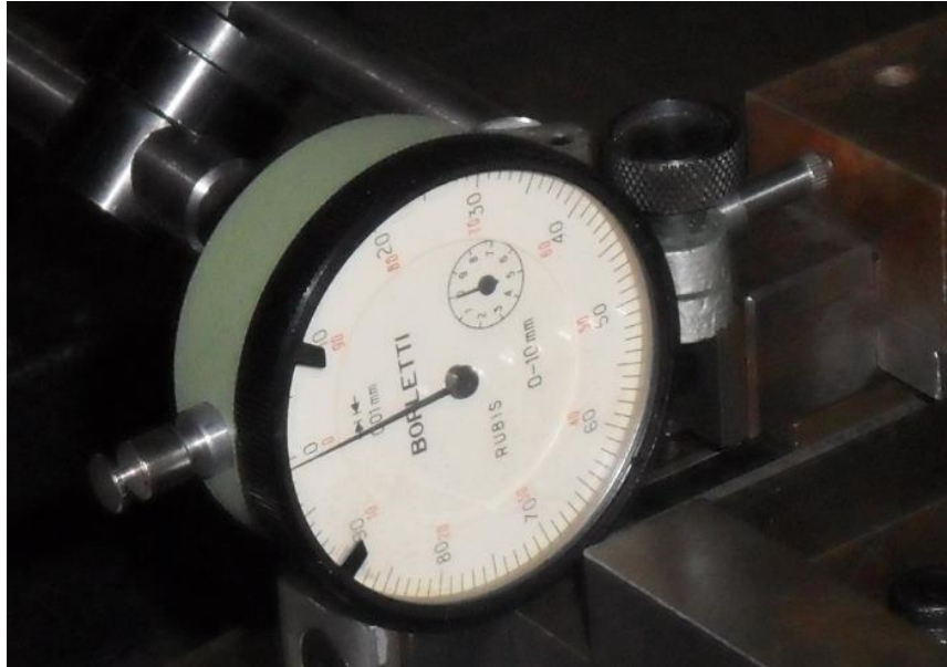
Figura 7.4: Posizione del comparatore prima dello spostamento. Si osserva la punta del comparatore posizionata perpendicolarmente al piano motorizzato e le due lancette del comparatore posizionate sullo zero.
