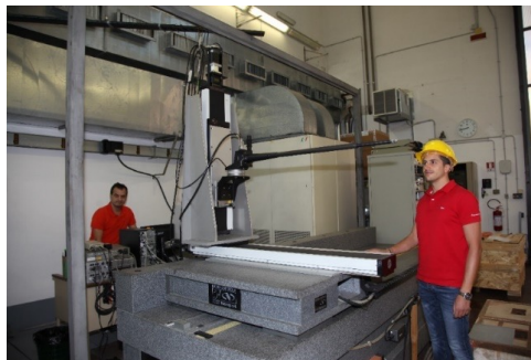
Sonda di Hall montata su banco di allineamento
