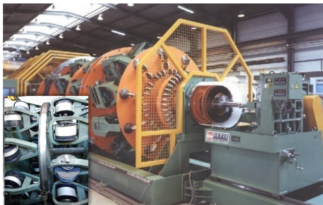
Macchina avvolgitrice planetaria per il petalo
