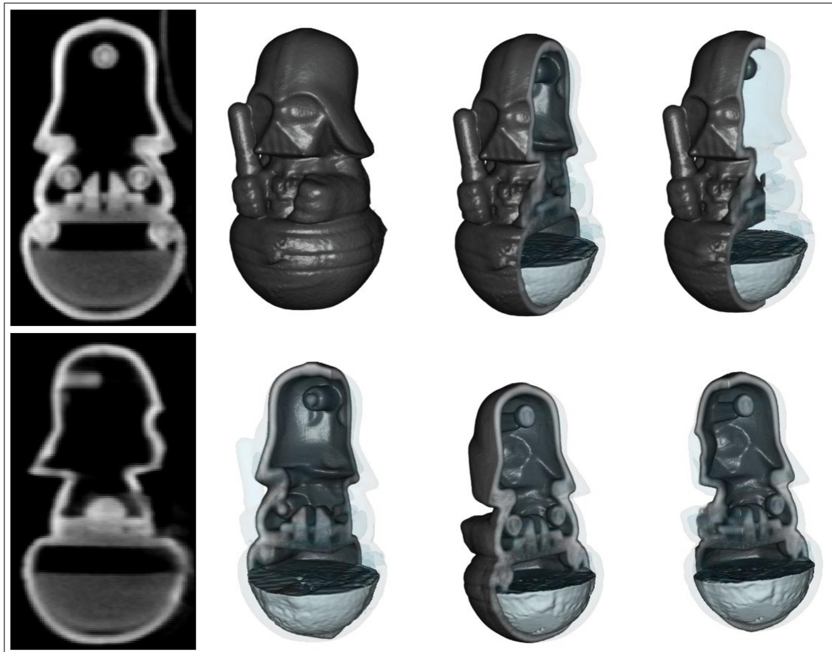
Rendering 3D a falsi colori della moneta da 1euro (ottenuta con Slicer3D) e della figura in plastica di Dart Fener
