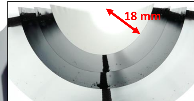
Metà sezione dei tre strati interni del modello di ITS3
