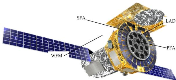
Configurazione schematica degli strumenti a bordo del satellite eXTP. La strumentazione comprende: lo Spectroscopic Focusing Array (SFA), il Large Area Detector (LAD), il Polarimetry Focusing Array (PFA) e il Wide Field Monitor (WFM) [1, 2].
