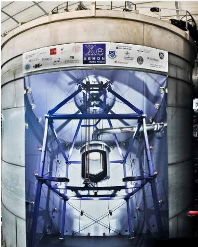
L'esperimento Xenon 1T, rivelatore per la ricerca diretta della materia oscura, in attività ai Laboratori Nazionali del Gran Sasso dell'INFN. L'esperimento The Xenon 1T experiment, detector for the direct search for dark matter, in operation at the INFN Gran Sasso National Laboratories.
