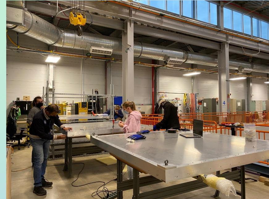
**Uso del laboratorio di criogenia per l'assemblaggio del sistema per il test dei SiPM di DUNE dopo i cicli termici**
