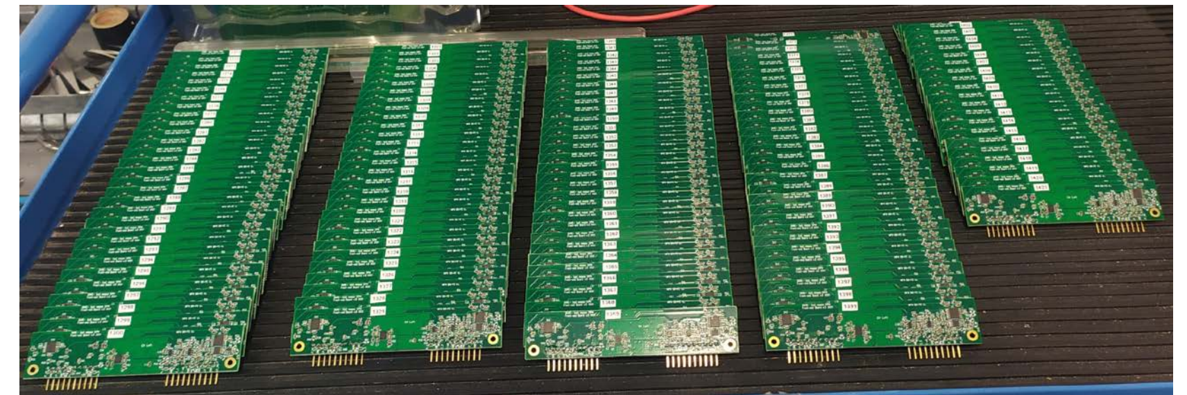
270 schede Front-end due canali per il sistema di test dei SIPM per Nu@FNAL [Lax]
