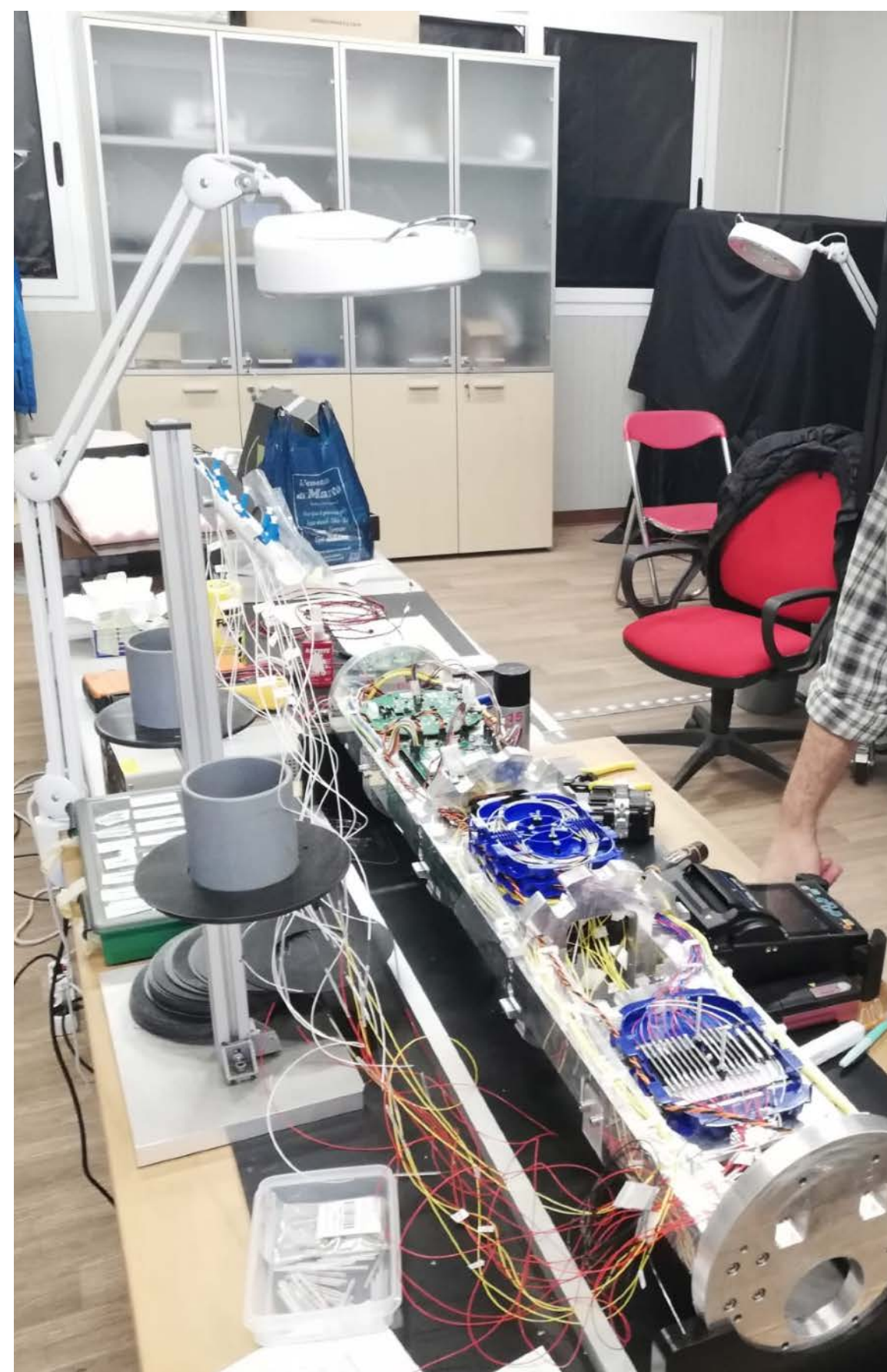
Supporto alla realizzazione del primo modulo di base con tecnologia Wet White Rabbit Switch presso il sito di produzione di Caserta per l'esperimento KM3NeT [Pellegrini]
