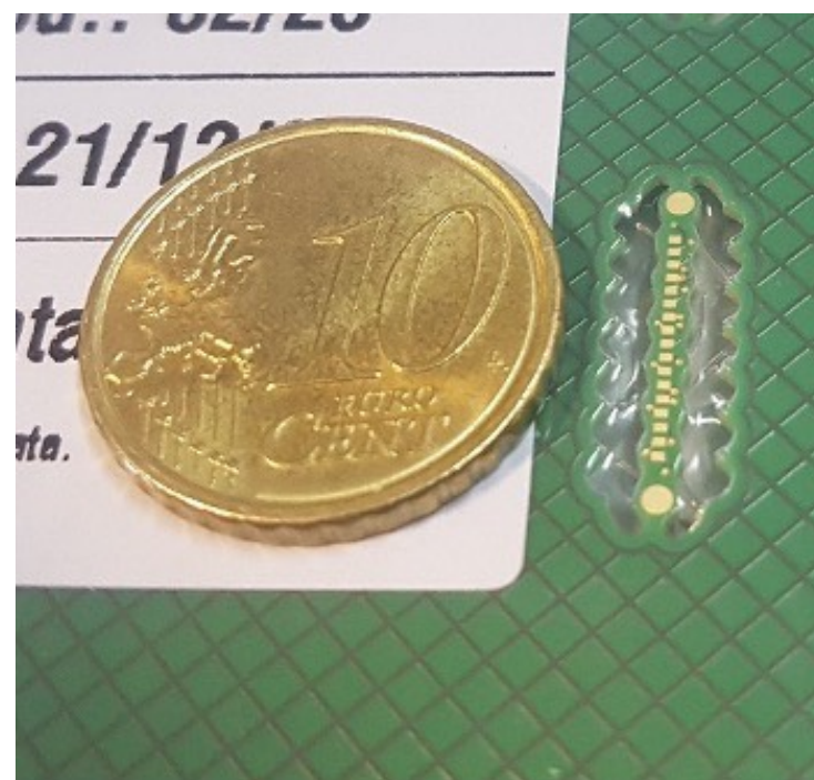
Realizzazione di una micropatch tra SiPM e cavo a 16 poli 30 AWG per HIDRA2 [Veri]
