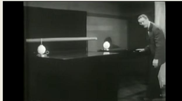
Nel film la massa viene accelerata da **forze che si visualizzano, si confrontano e si sommano attraverso l'effetto «deformazione»** su un corpo elastico.. Notiamo che solo alla fine del film, un po' per scherzo e un po' per correttezza si rivela il «trucco», evidenziandone l'irrelevanza agli effetti della II legge
