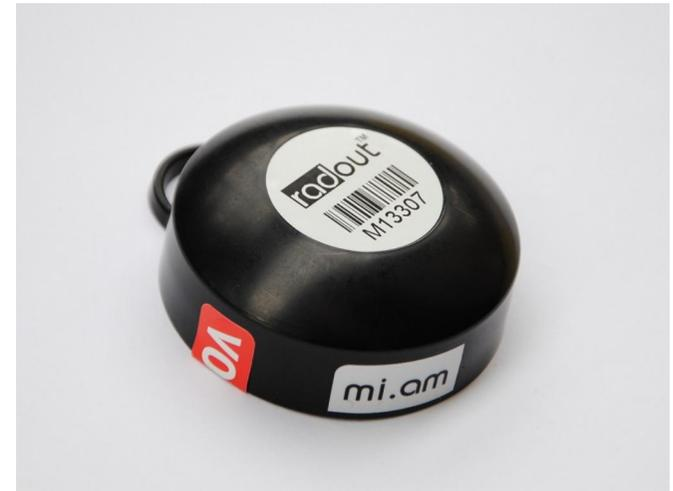
Il Radon è un gas nobile prodotto nella catena dell'uranio ed ha un tempo di dimezzamento lungo; può quindi infilarsi insieme all'aria all'interno della scatolina attraverso la fessura presente e decadere all'interno, rilasciando la sua radioattività nel mio strumento.
