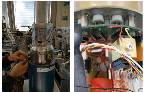
Installazione della prima capsula nel criostato di test. Caratterizzazione del rivelatore e dell'elettronica di front-end
