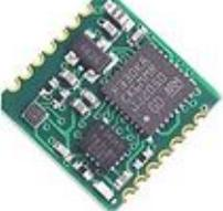
[Bussola elettronica da 500 Hz + sensore di inclinazione]
