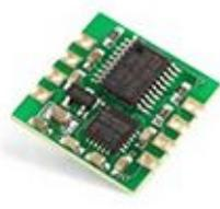
[Accelerometro WT61+sensore di inclinazione]
