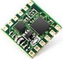
[Accelerometro WT61P + sensore di inclinazione]
