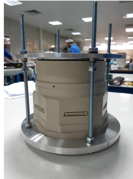
Test di tenuta gas delle flange
