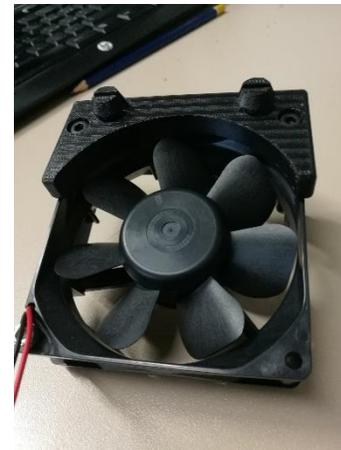
Progettazione di supporti per ventilazione e raffreddamento supplementare di alimentatori montati presso il FNAL e realizzati in stampa 3d.
