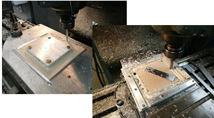
Realizzazione di una sottile cornice prototipo in peek. Questa costruzione ha necessitato della progettazione e costruzione di un'opportuna attrezzatura per la lavorazione su fresatrice.
