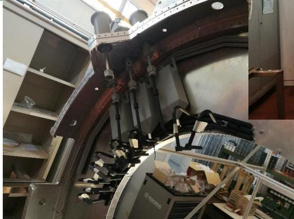
Per Atlas ITK è stato implementato il mokup a Frascati con elementi stampati in materiale plastico che riproducono il sistema di refrigerazione. Contributo anche per il montaggio delle attrezzature di allestimento del Calorimetro.
