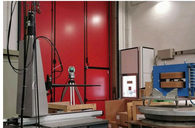
Allineamento di precisione con Laser Tracker
