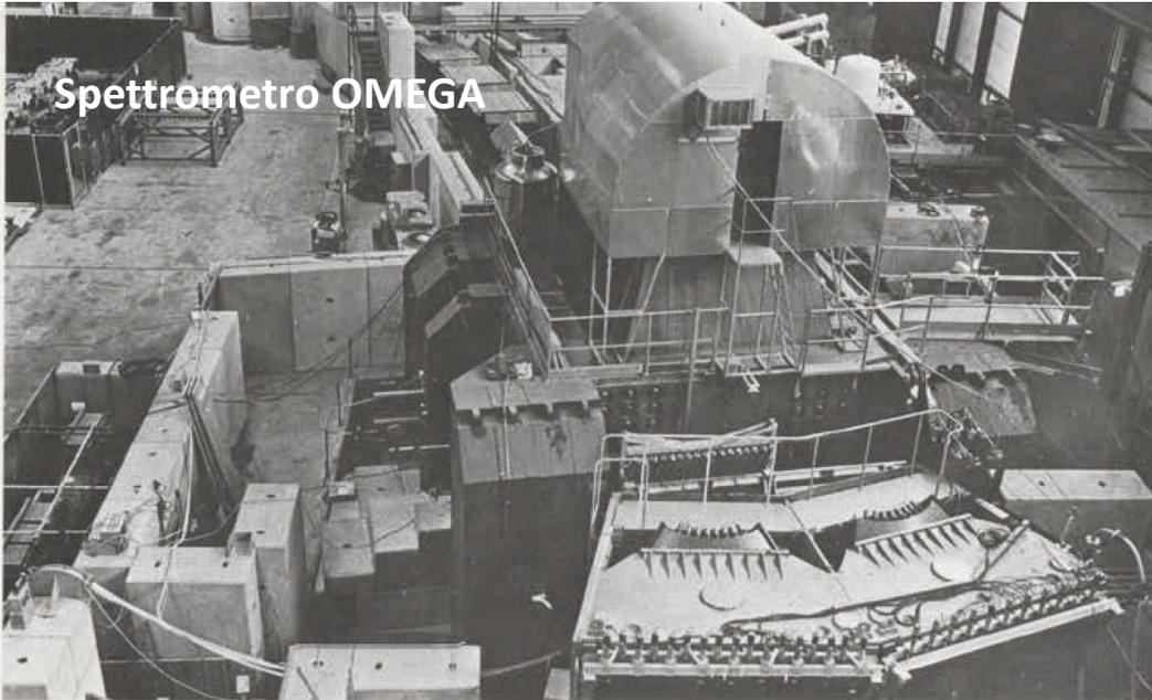
Lo spettrometro magnetico Omega è uno dei grandi rivelatori del CERN: il magnete superconduttore ha un diametro interno della bobina di 3 m, con una distanza di 2 m fra i poli, ed il campo magnetico raggiunge i 18 kgauss. La rivelazione è realizzata da camere a scintille lette da 8 camere televisive. Gruppi delle Sezioni di Bari e Milano hanno partecipato ad esperimenti con Omega, e collaborato alla realizzazione dei complessi programmi necessari per la ricostruzione degli eventi. (foto CERN)
