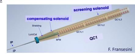
Final Focus Quadrupole QC1 design: CCT Final Focus SC quadrupole, max gradient 100 T/m, 4.2 K (disegno preso da SuperB, stessi constraints di spazio)
