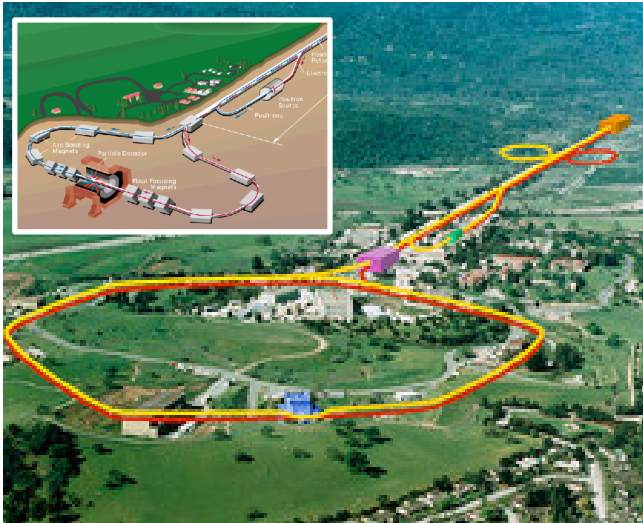
SLAC (California, USA) Collider elettrone positrone 3 km, E~100 GeV
