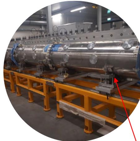
Contributo alla **European Spallation Neutron Source (SVEZIA)**: costruzione del **drift tube Linac**:
