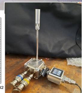
La **microdosimetria** misura la fluttuazione stocastica del deposito energetico alla scala del micron, che è strettamente correlata all'efficacia biologica della radiazione.
