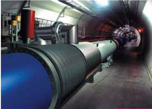
Gli acceleratori utilizzano intensi campi elettrici per dare energia ai fasci di particelle e campi magnetici per guidare i fasci nella macchina. Gli acceleratori più grandi sono circolari. Al loro interno, le particelle sono guidate da campi magnetici. In questo modo le particelle possono acquistare ad ogni giro sempre più energia.
