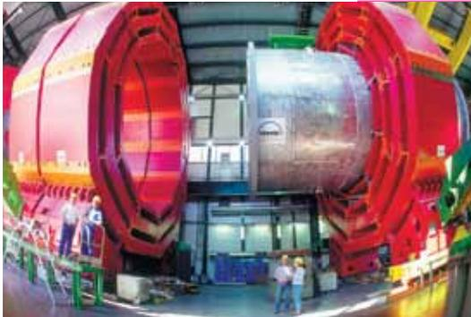
I vari "strati" del rivelatore misurano le diverse proprietà delle particelle prodotte nelle collisioni. I rivelatori di traccia danno informazioni sul percorso delle particelle dal punto di collisione verso l'esterno del rivelatore. Altri strati, chiamati calorimetri, misurano l'energia delle particelle. Un magnete costruito intorno al centro del rivelatore, curva la traiettoria delle particelle cariche ed aiuta così ad identificare il tipo di particella.
