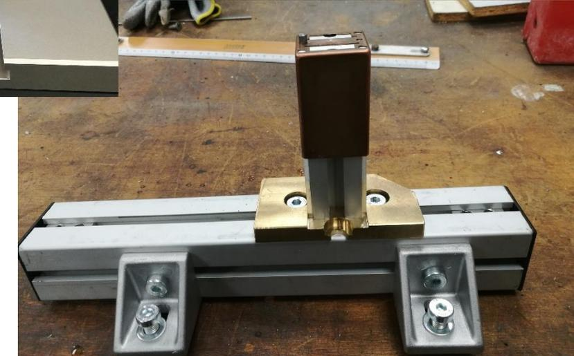
Questo oggetto fungerà da supporto per la marchiatura delle Faraday cages, permettendo di effettuare rapidamente la suddetta operazione che riguarderà oltre 1500 pezzi. L'oggetto è stato realizzato interamente con materiali recuperati presso l'officina ed.17.
