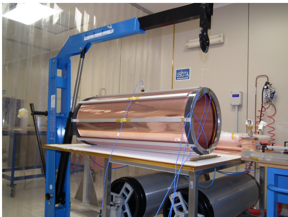
Figura 17: Configurazione Drop Test Gancio - Asse X
