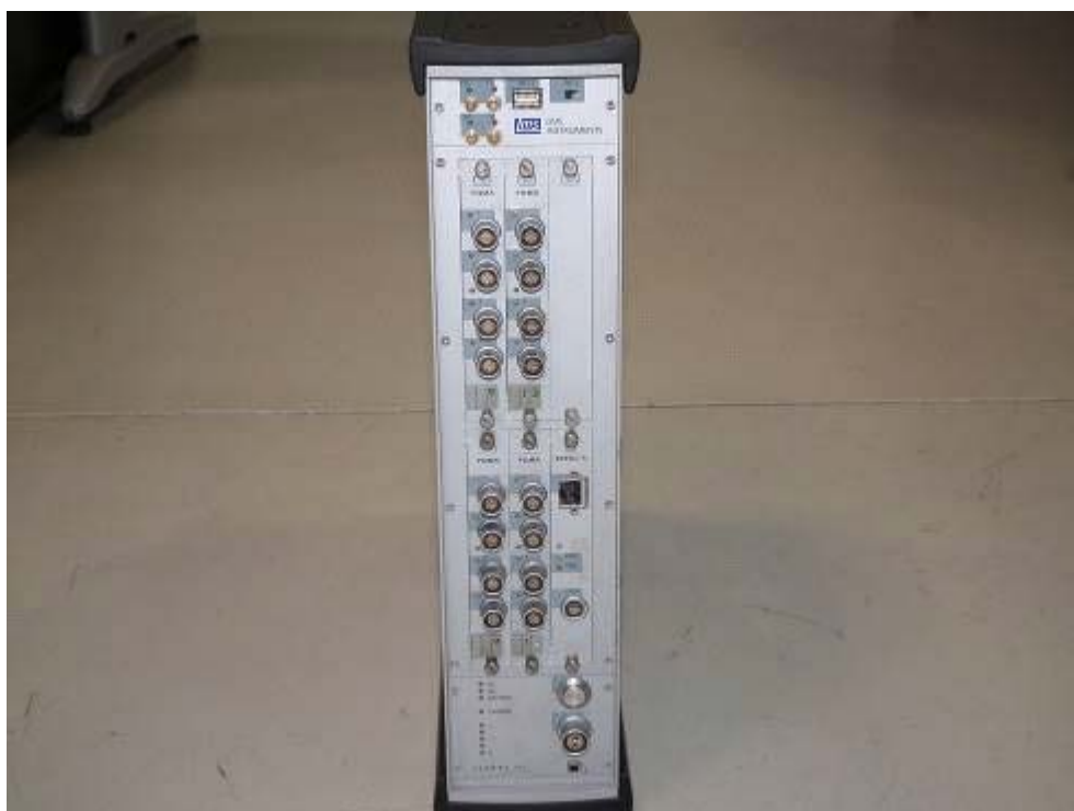
Figura 8: LMS SCADA SC305, 16 canali - 24bit ADC
