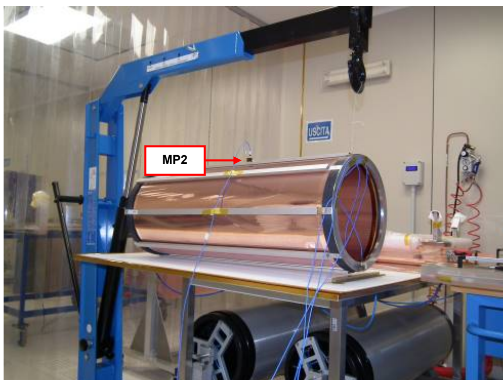
Figura 11: Accelerometro Misura MP2 – Flangia Laterale
