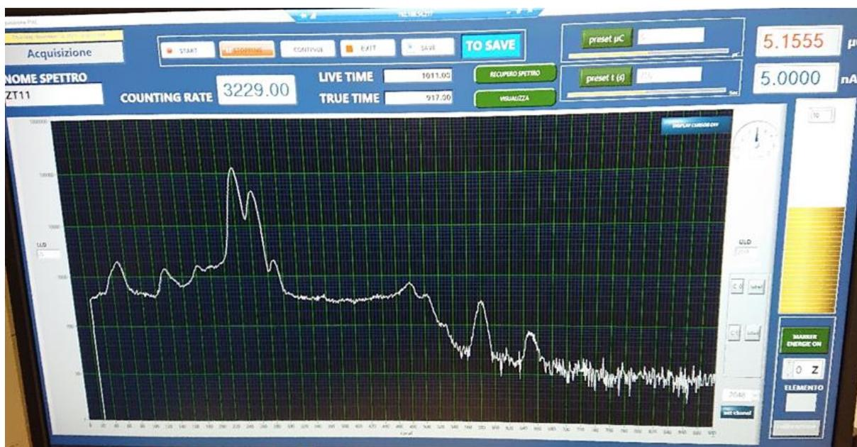
Fotografia del grafico conteggi/canale fornito dal software di acquisizione.
