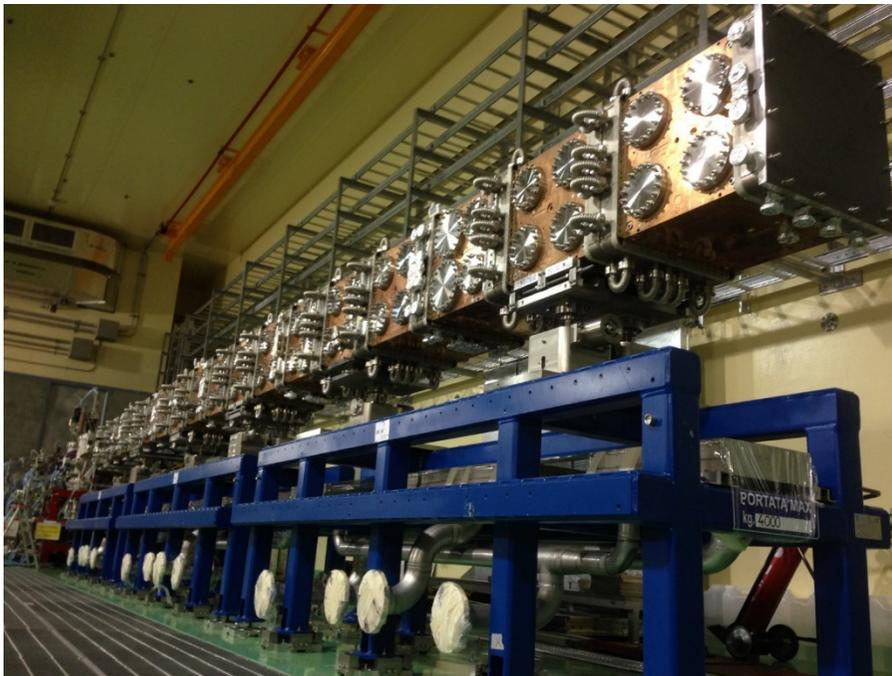
**Acceleratore lineare** drift tube linac (DTL), installato a Lund (Svezia), contributo per il progetto European Spallation Source (ESS).
