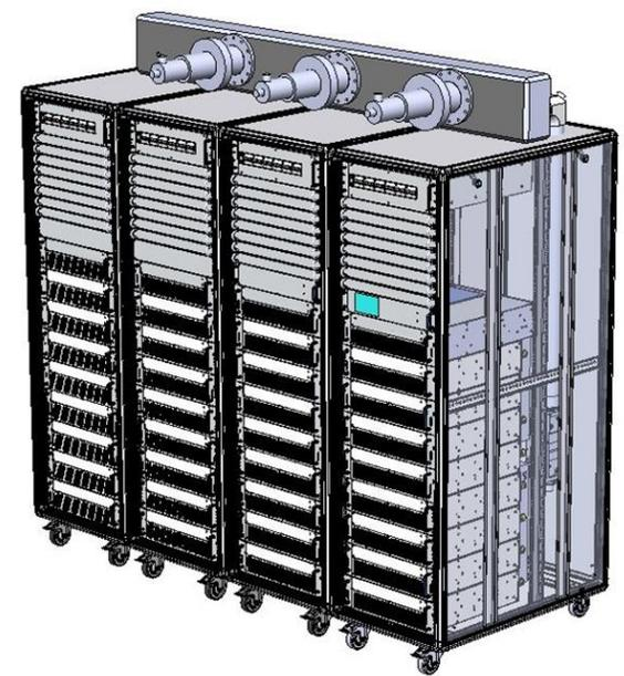
**Prototipo INFN di amplificatore allo stato solido (200 kW cw, 175 MHz), in costruzione nell'industria nazionale.**
