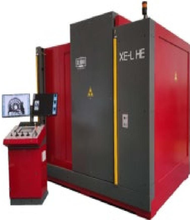
Nel laboratorio di analisi non distruttive presente in Casaccia è stato acquistato un Tomografo Industriale della Gilardoni, con le specifiche indicate:
