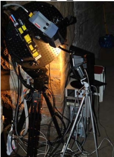
Catacomba di S.Alessandro (Roma) Diagnostiche in-situ su affreschi romani LIF e TG-LIF, XRF, Raman ENEA-FSN-TECFIS-DIM – INFN-Sez.RM2
