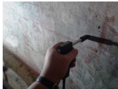
Catacomba di S.Alessandro (Roma) Diagnostiche in-situ su affreschi romani LIF e TG-LIF, XRF, Raman ENEA-FSN-TECFIS-DIM – INFN-Sez.RM2
