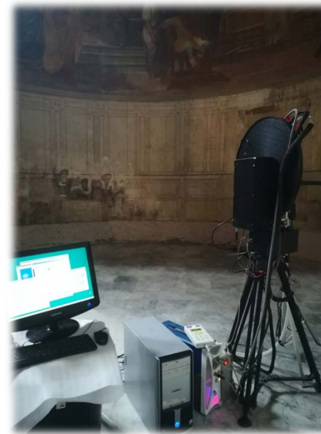
Basilica di San Nicola in Carcere (Roma) Diagnostiche in-situ su affreschi ottocenteschi LIF e TG-LIF, FT-IR, XRF, Raman ENEA-FSN-TECFIS-DIM – INFN-Sez.RM2, INFN-LNF
